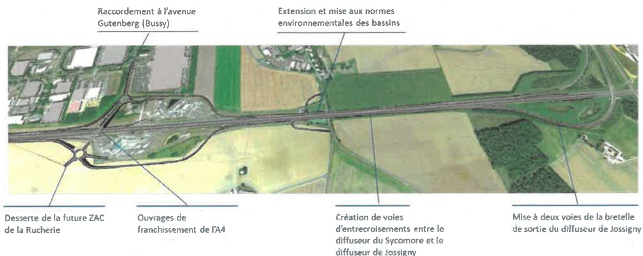
Figure 5 : Synoptique de l'aménagement du diffuseur (maquette BIM)
