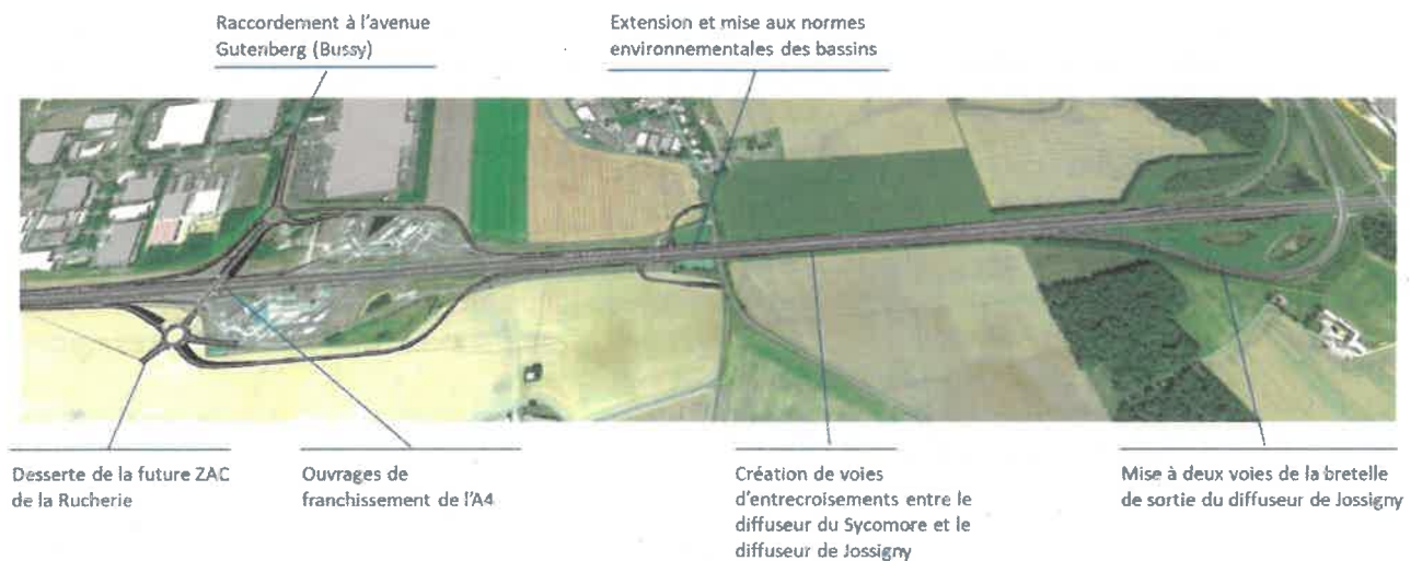
Figure 5 : Synoptique de l'aménagement du diffuseur (maquette BIM)
